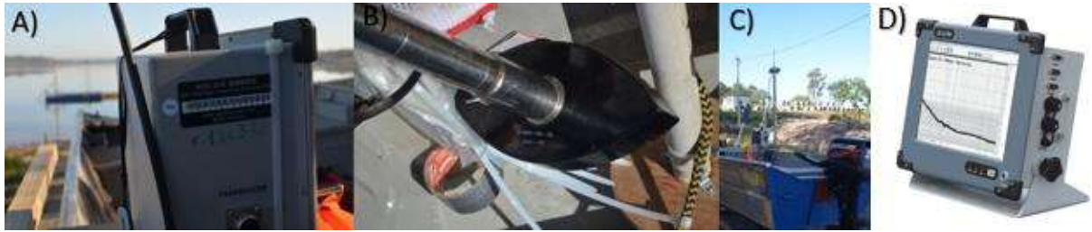
Figura 10 – Ecobatímetro. A) Modelo do ecobatímetro. B) Sonda. C) Barco - Chata. D) Tela TFT-LCD.
