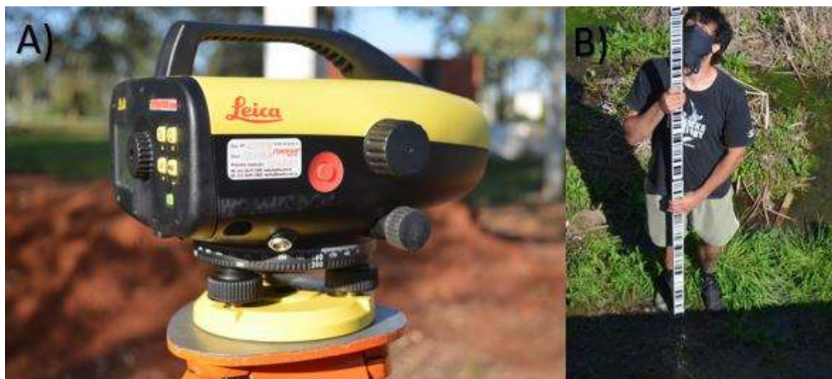
Figura 14 – Equipamentos utilizados para topografia A) Nível eletrônico. B) Régua com código de barras.
