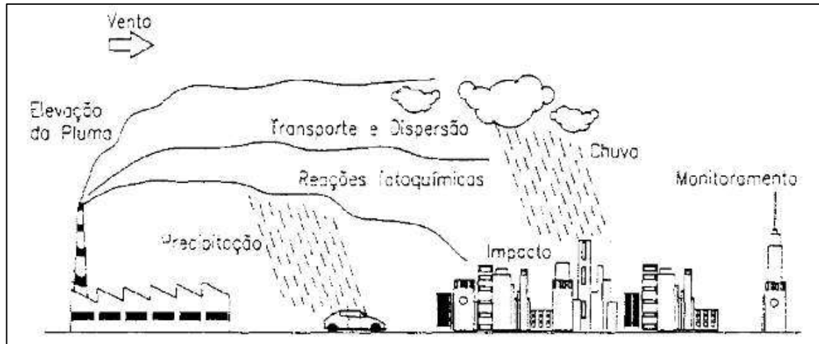
Figura 8 - Modelo de dispersão de gases na atmosfera. Fonte: Maioli e Nascimento, 2005.
