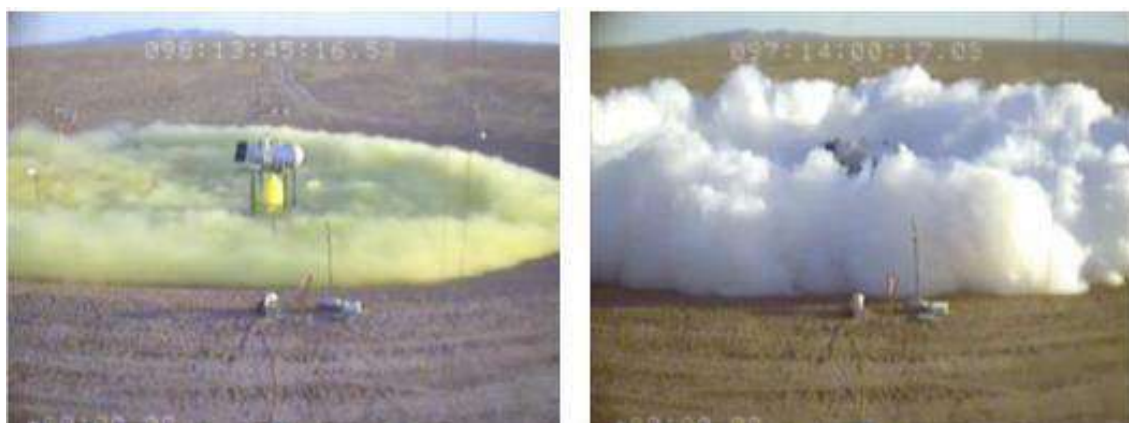
Figura 17 - Vazamento de amônia (direita) e cloro (esquerda) – Fase 3. Fonte: Guía Operativa – Actuaciones con amoniaco para bomberos V1 – 2019.
