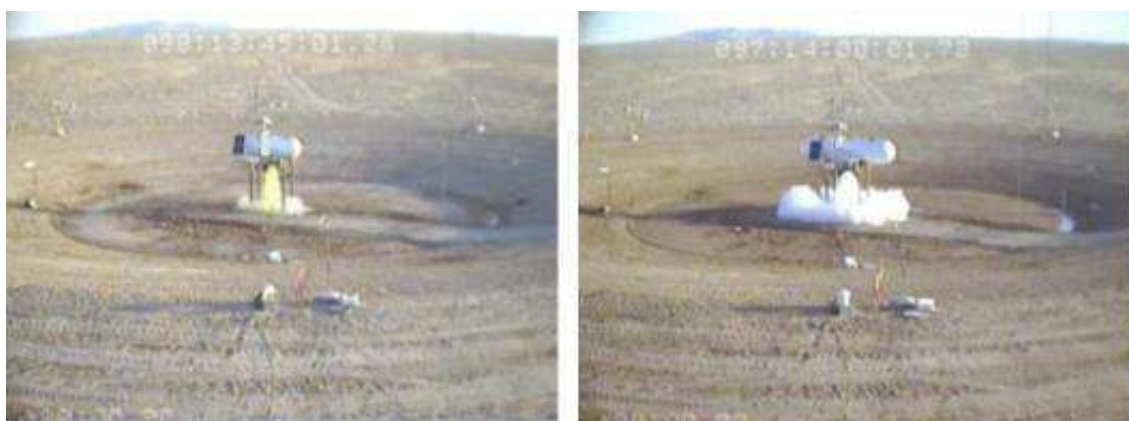
Figura 15 - Vazamento de amônia (direita) e cloro (esquerda) – Fase 1.
