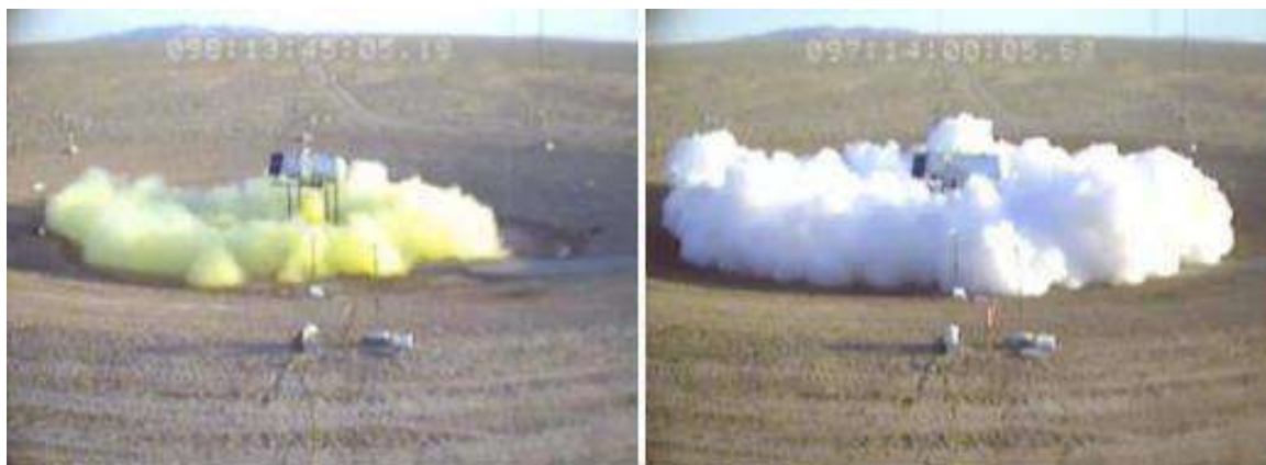
Figura 16 - Vazamento de amônia (direita) e cloro (esquerda) – Fase 2. Fonte: Guía Operativa – Actuaciones con amoniaco para bomberos V1 – 2019.
