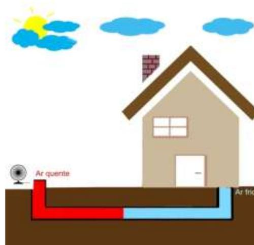
Figura 1: Funcionamento de um TCSA em dias quentes.
