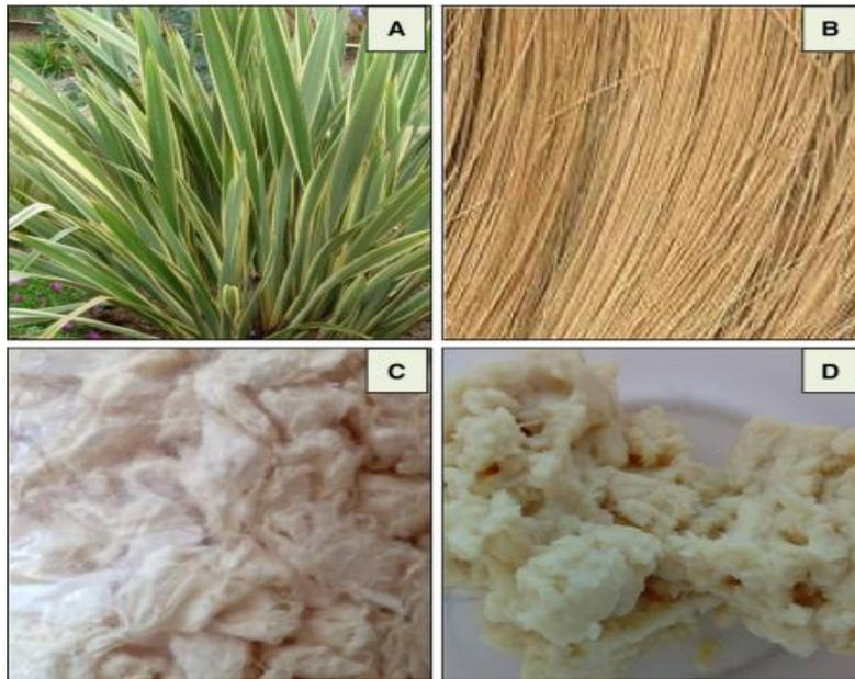
Figura 2: A) Planta (*Phormium tenax*) B) Fibras da planta *Phormium tenax* C) Fibras alcalinizadas e branqueada D) fibras refinadas.
