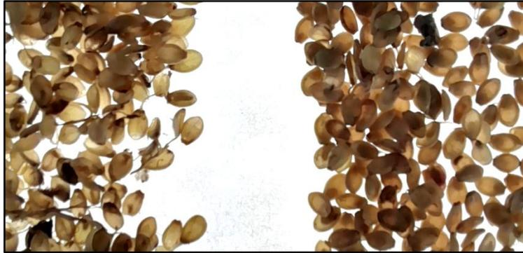
Figura 9: Sementes escarificadas sobre o diafanoscópio (à esquerda sementes vazias e à direita sementes cheias).
