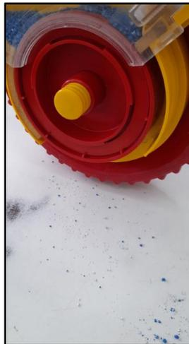
Figura 21: Material do recobrimento desprendido do pélete após o uso da semeadora.
