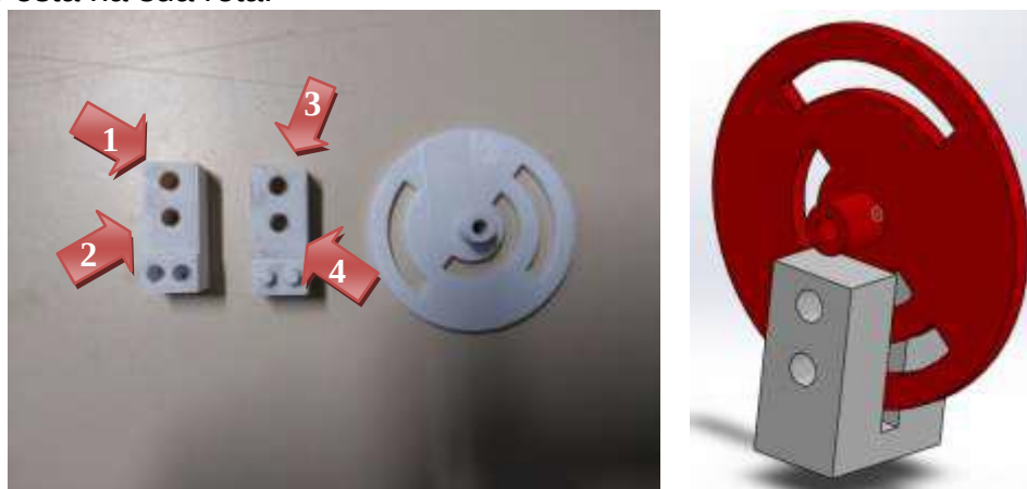
Figura 3 – Imagem da esquerda são os componentes do encoder fabricados através de impressão 3D e a imagem da direita o desenho do conjunto desenvolvido em software de modelagem 3D.
