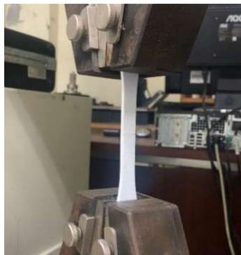
Figura 2 – Corpo de prova preso à máquina de tração.
