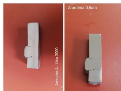
Figura 2 Amostra A aço inovador e o polimento com alumina 0,5 micrômetro; Fonte: Autores.
