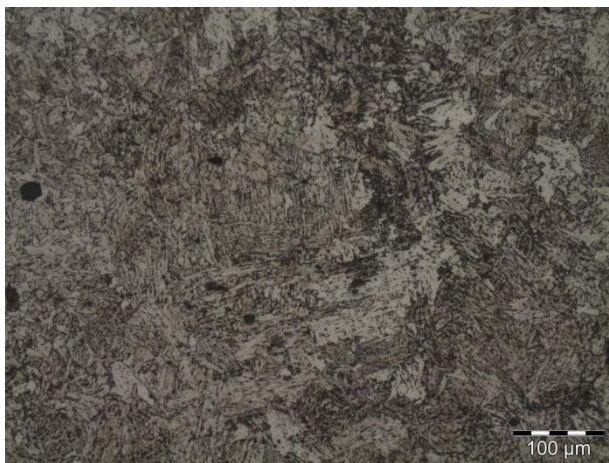
Figura 4 aço novo região do metal de solda (WM) microscópio óptico com aumento de 200x; Fonte: Autores.
