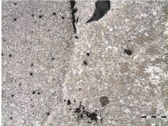
Figura 3 Amostra A aço inovador zona de transição metal base(BM), zona afetada pelo calor (ZAC) e Metal de solda (WM). Fonte: Autores.
