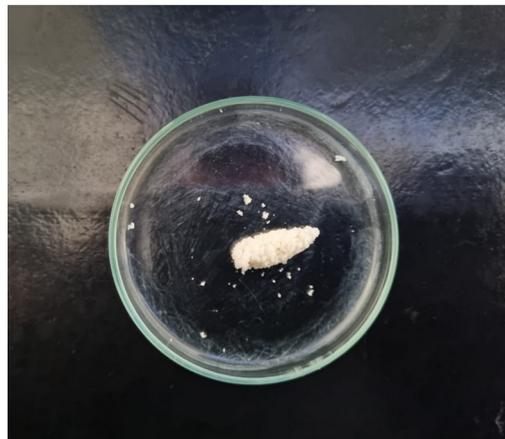
Figura.2 Material obtido à partir da síntese de CaO
