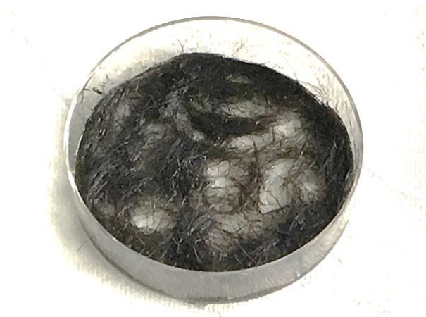
Figura 12. Aspecto dos fios de cabelo fortificados com halogênios como estratégia de calibração para a determinação de bromo, cloro e iodo por LA-ICP-MS.
