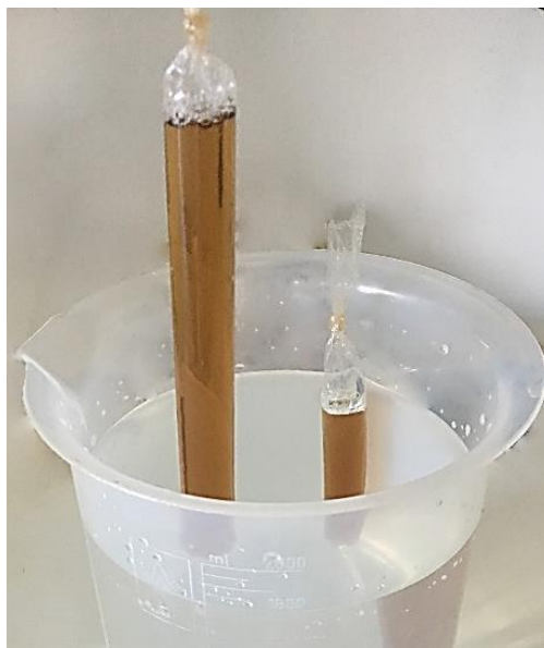
Figura 14. Filtrado de queratina extraída do cabelo sendo dialisado.
