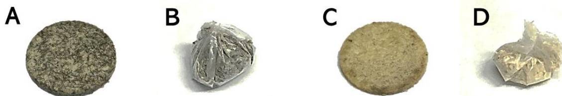
Figura 8. Cerca de 100 mg de amostra de cabelo preparadas na forma de A) pellet e B) invólucro e de unha preparadas na forma de C) pellet e D) invólucro.
