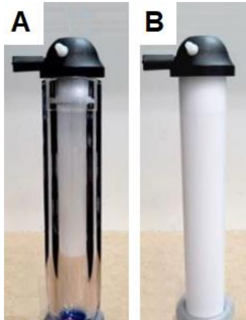
Figura 5. A) frasco de quartzo utilizado na MIC e B) frasco de PTFE-TFM utilizado na MAD e MAE (Adaptado de PEREIRA, 2014).
