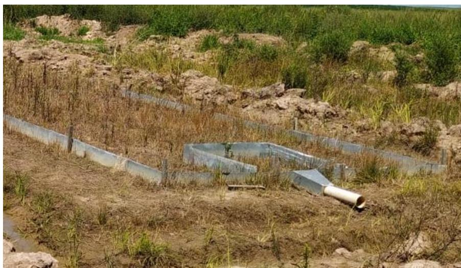
Figura 5. Parcela delimitada para a coleta de enxurrada para determinação de perda de sedimento e água. Estação experimental agrônômica da Palma-UFPel, Capão do Leão-RS. Fonte: Autora.
