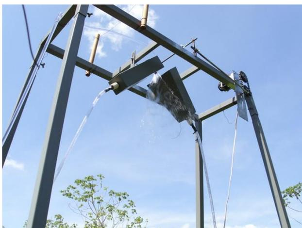
Figura 3. Simulador de chuvas portátil, calibrado, com bico aspersor Veejet 80-100. Fonte: Faria Júnior et al. (2013).
