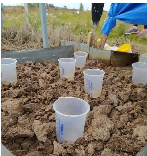
Figura 4. Distribuição dos beckers para calibração e coleta de chuva simulada em parcela de 1 m<sup>2</sup>, localizado na estação experimental agrônômica Palma-UFPel, Capão do Leão-RS. Fonte: Autora.
