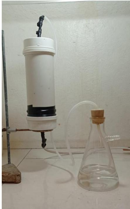
Figura 1 - Sistema de simulação de silo armazenador para ozonização das sementes
