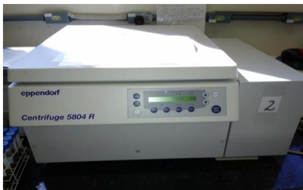
Figura 26. Centrífuga utilizada para caracterizar as formulações nanoestruturadas.
