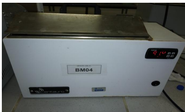
Figura 27. Banho-maria utilizado para caracterizar as formulações nanoestruturadas.
