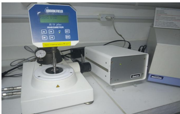
Figura 24. Viscosímetro utilizado para caracterizar as formulações nanoestruturadas.
