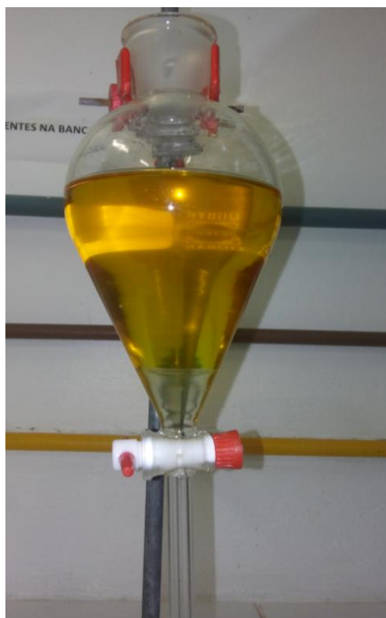
Figura 10. Imagem do biodiesel formado, na fase superior.
