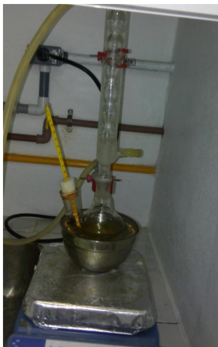
Figura 9. Imagem do sistema de refluxo para a síntese do biodiesel.
