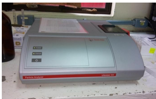
Figura 22. Analisador de partículas utilizado para caracterizar as formulações nanoestruturadas.
