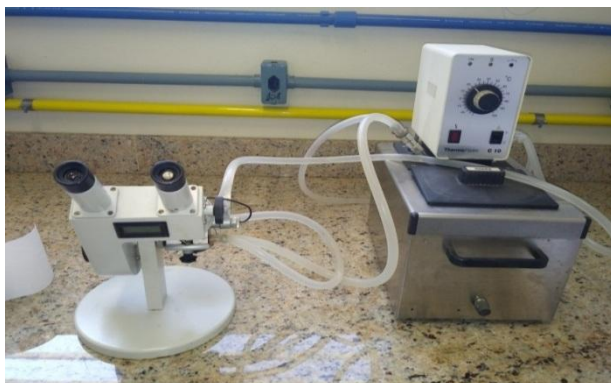
Figura 25. Refratômetro utilizado para caracterizar as formulações nanoestruturadas.
