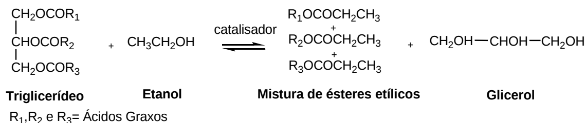
Figura 13. Esquema da reação de transesterificação.
