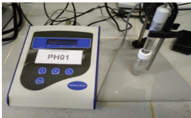
Figura 23. Equipamento utilizado na determinação do pH das formulações nanoestruturadas.
