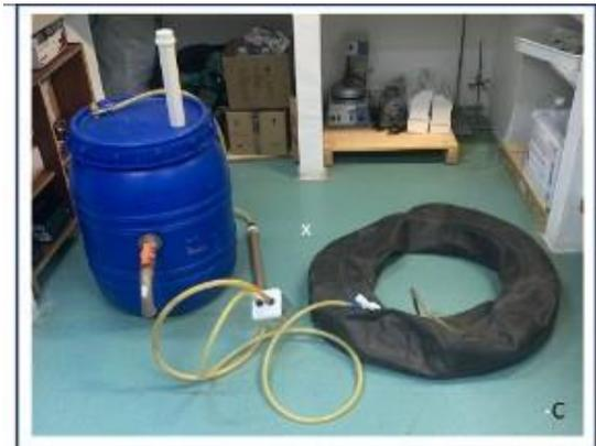
**Figura 1** – Construção do biodigestor. A: materiais utilizados. B: tambor de digestão. C: biodigestor com sino para armazenamento do biogás.
