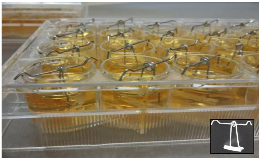
Figura 3 – Placa de 24 cavidades de poliestireno com corpos de prova submersos em caldo BHI de forma que ficassem suspensos nos poços. Em destaque à esquerda o corpo de prova completo.
