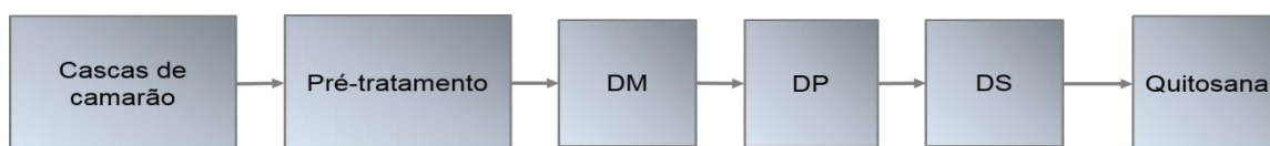
Figura 6 – Fluxograma do processo de obtenção da quitina e quitosana.
