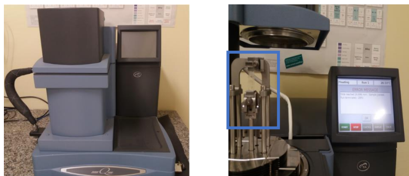
Figura 31 – Analisador mecânico-dinâmico (AMD) Q800TM (esquerda). Suporte de tração com a amostra de filme em destaque (direita).
