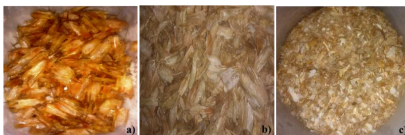
Figura 7 – Pré-Tratamento das cascas: catação e limpeza (a), cascas secas (b) e cascas trituradas (c)
