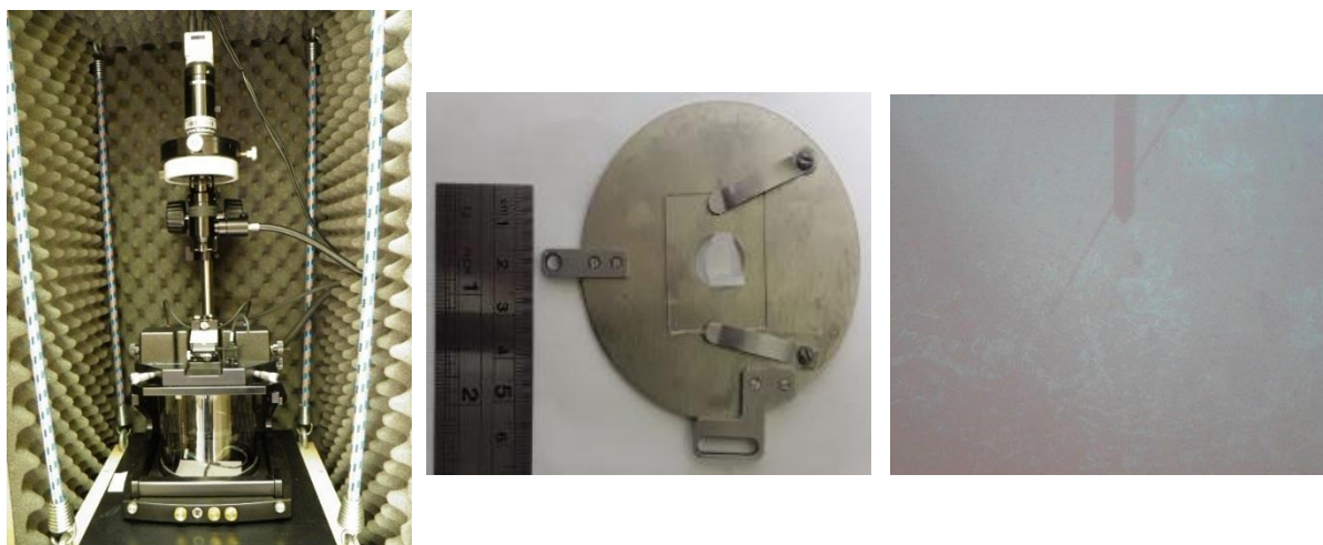
Figura 12 – Foto do Microscópio de força atômica (esquerda); preparo da amostra no porta amostra (central); foto da ponteira visualizada pelo software acoplado ao AFM no início da digitalização (direita).
