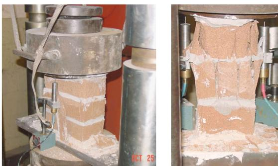
(b) Peça de alvenaria submetida ao Ensaio de Tração.
