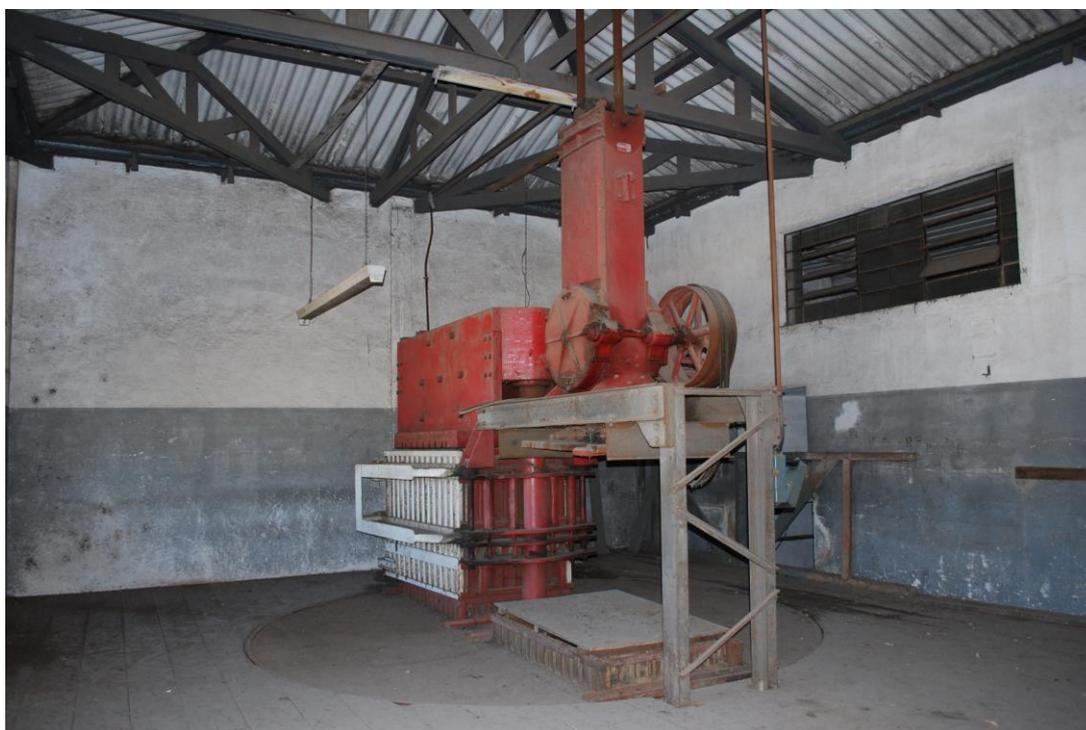
Figura 14 - Prensa que comprimia lã em tops. 2012
