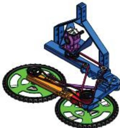
Figura 45 - Concepção da roçadora articulada para realizar limpeza entre linhas.
