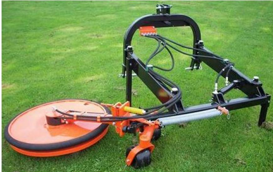
Figura 23 - Disco móvel para roçadoras.
