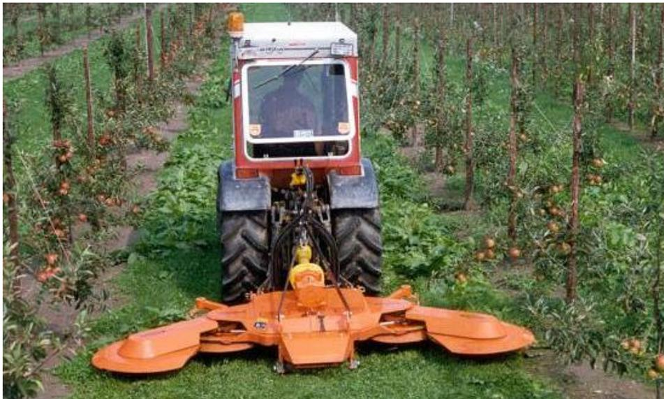
Figura 22 - Roçadora modelo Perfect com dois discos móveis
