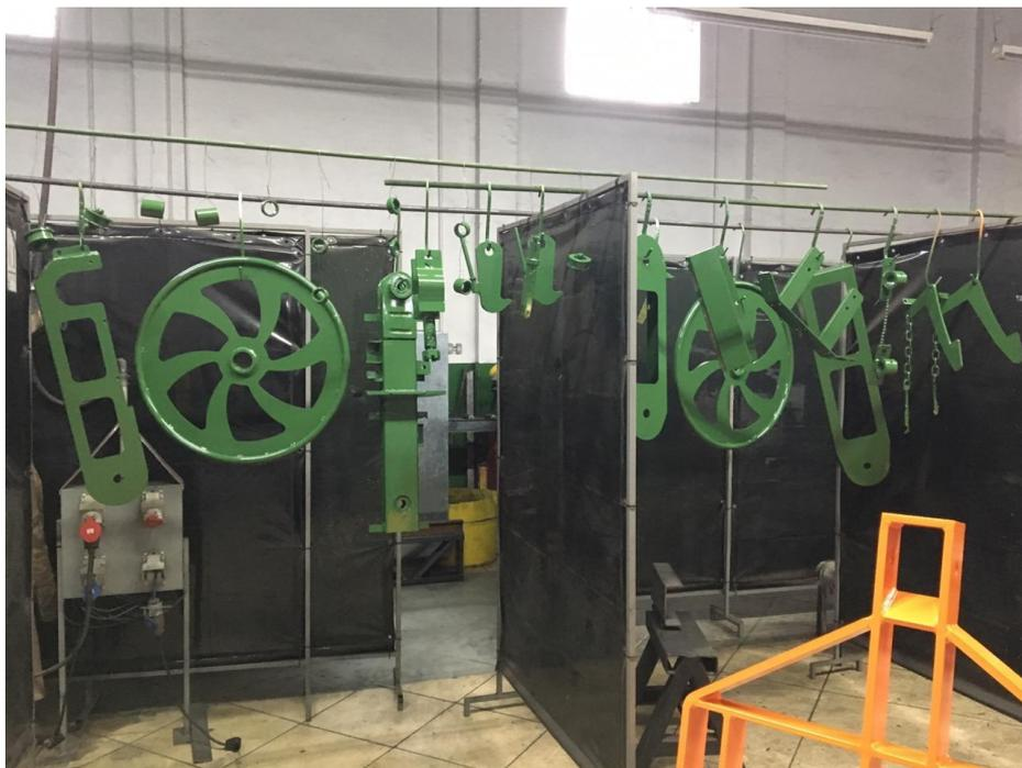
Figura 57 – Pintura dos itens manufaturados.
