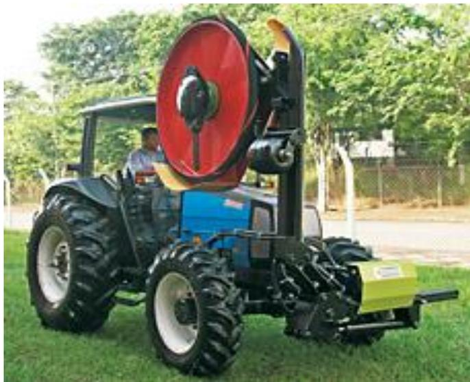
Figura 20 - Roçadora Frontkop 115II EX em posição de transporte.
