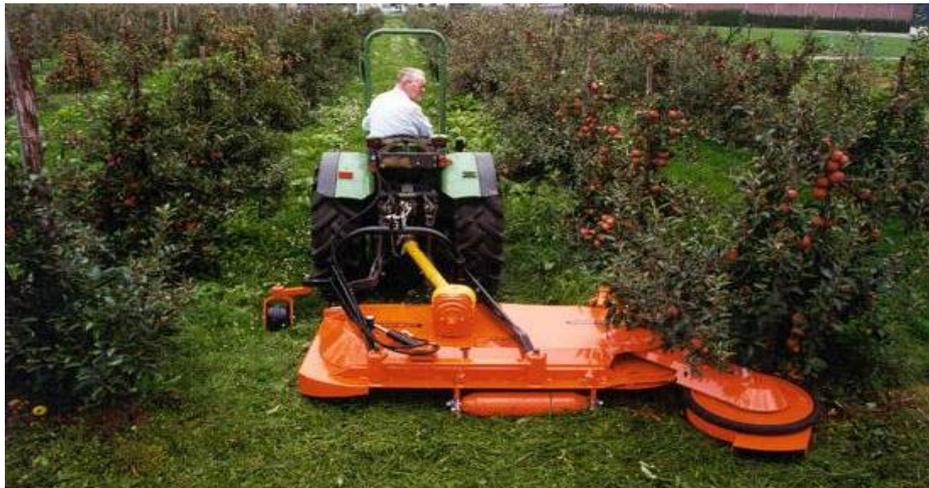
Figura 21 - Roçadora modelo Perfect com um disco móvel.
