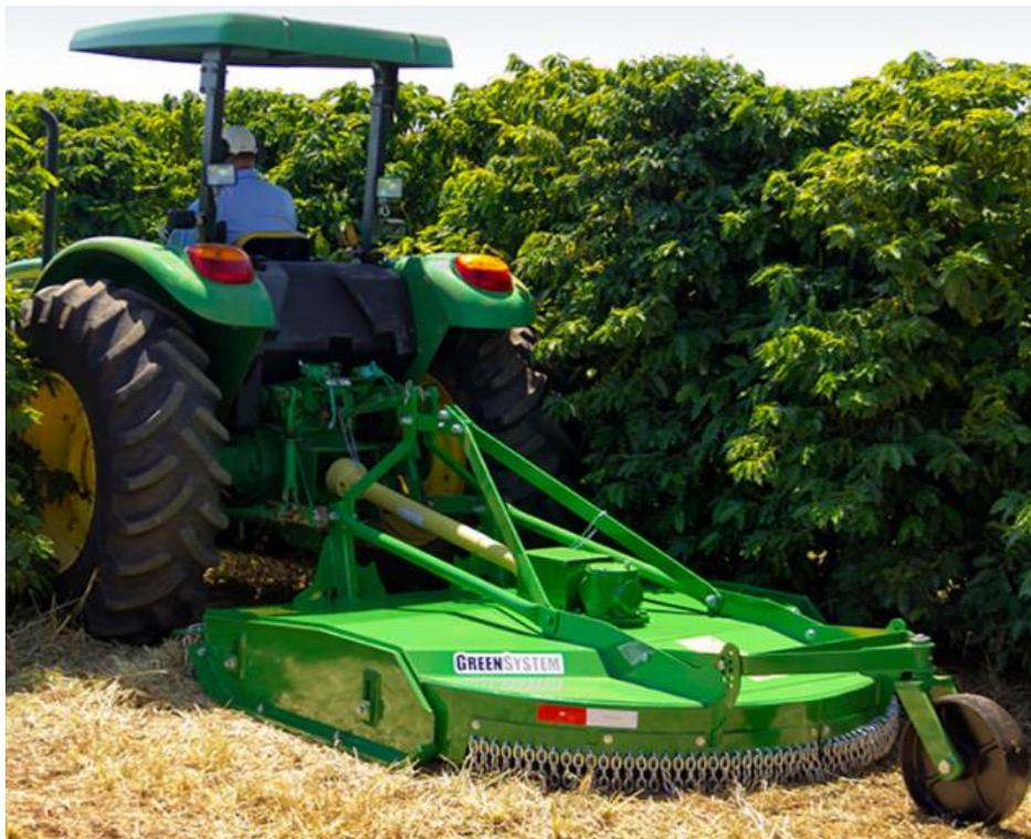
Figura 14 – Roçadora *Green System*<sup>TM</sup> Série RG.
