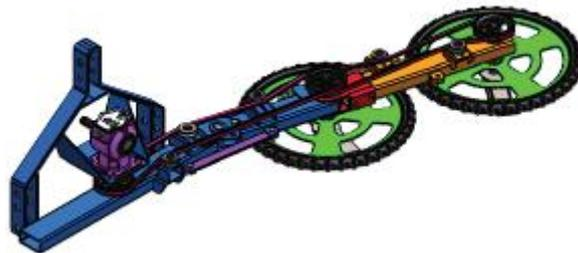
Figura 44 - Concepção da roçadora articulada para realizar limpeza entre plantas.
