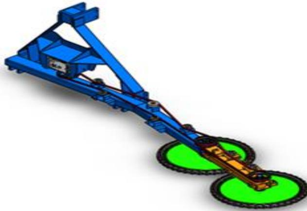
Figura 41 - Concepção da roçadora para realizar limpeza entre plantas com dois sistemas de corte.
