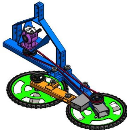
Figura 43 - Concepção da roçadora para realizar limpeza entre linhas.
