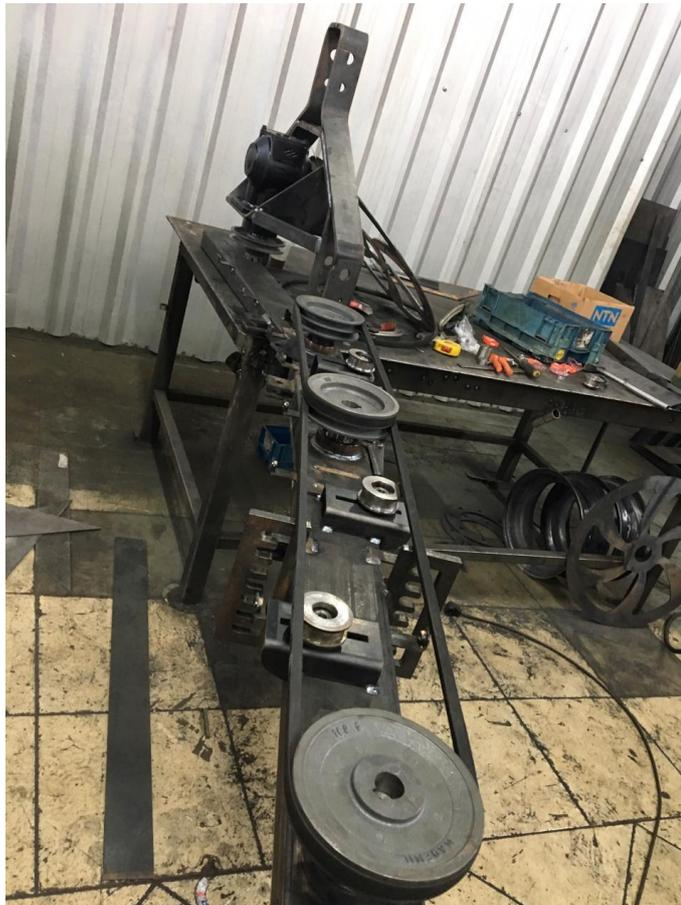
Figura 56 – Montagem e alinhamento dos componentes de transmissão.
