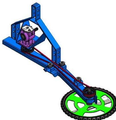
Figura 40 - Concepção da roçadora para realizar limpeza entre plantas com um sistema de corte.
