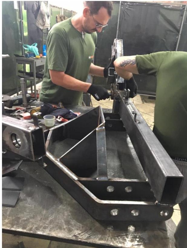
Figura 52 – Montagem do sistema de chassi.
