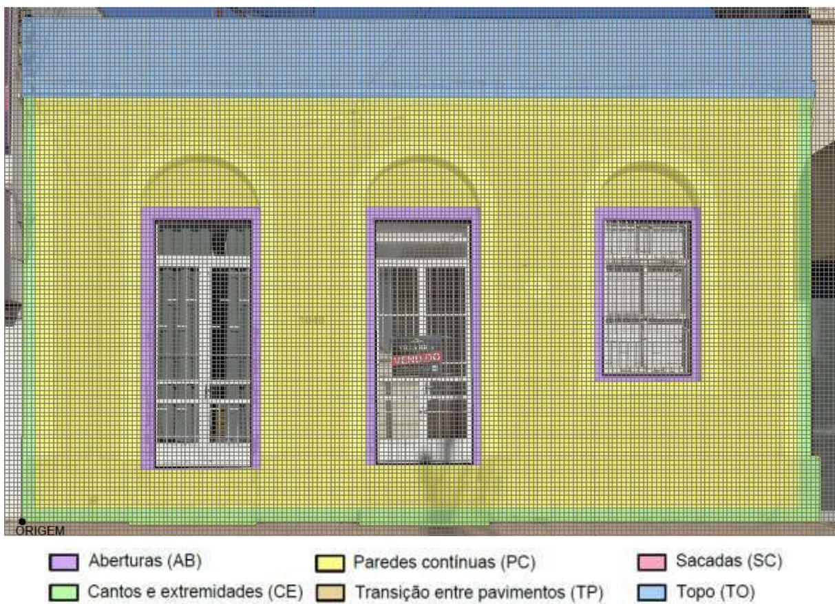
Figura 33. Divisão da fachada em regiões - edificação RS12-00016.
