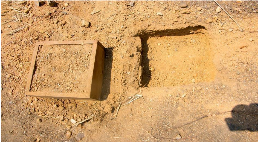
Figura 9 – Amostragem da macrofauna nos minesoils pelo método TSBF
