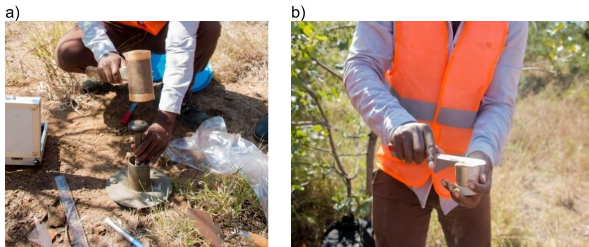
Figura 8 – Coletas amostras indeformadas utilizando anéis volumétricos.
