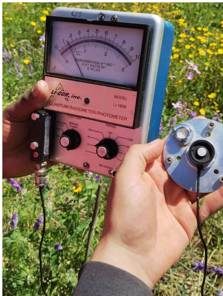
Figura 6 – Piranômetro portátil utilizado para avaliação da radiação solar global ao nível do solo
