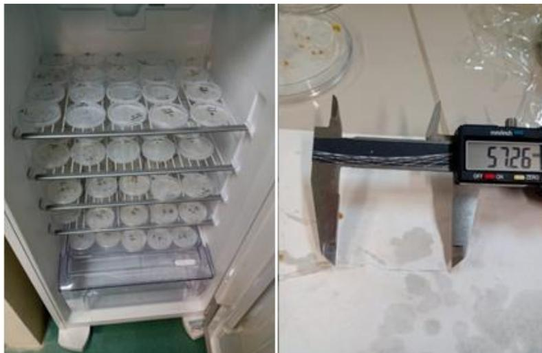
**Figura 7-** BOD e avaliação com paquímetro digital.
