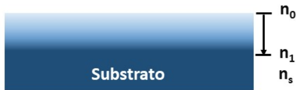
Figura 8 – Esquema ilustrativo de um revestimento antirreflexivo de índice gradual de refração depositado em um substrato.
