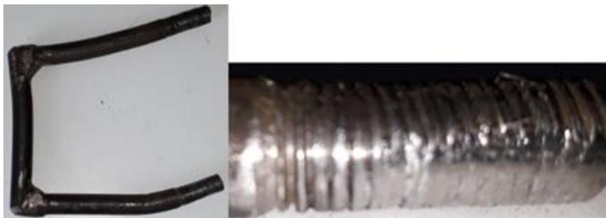
Figura 65 – Falha no componente de regulação da largura de trabalho.
