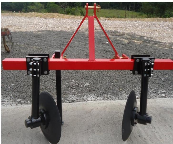
Figura 4 – Aleirador de discos para uma linha modelo AF 1.
