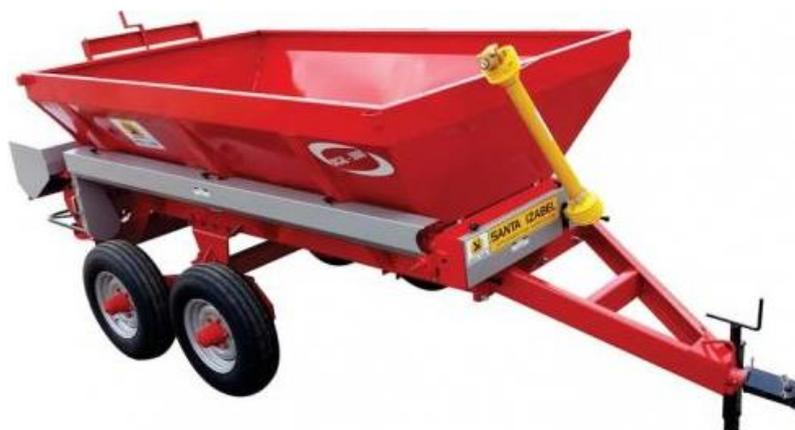
Figura 10 – Distribuidor de calcário, fertilizantes mineral ou orgânico, modelo DCSI 2500.
