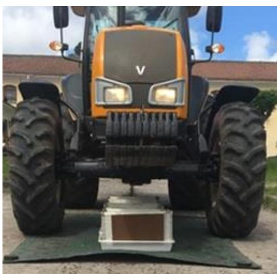
Figura 40 – Teste para medir a taxa de aplicação e a uniformidade de distribuição dos fertilizantes.
