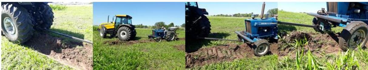
Figura 43 – Montagem do dispositivo para medição dos esforços de tração do protótipo.
