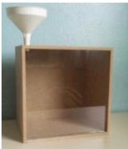
Figura 30 – Equipamento utilizado na determinação do ângulo de repouso.
