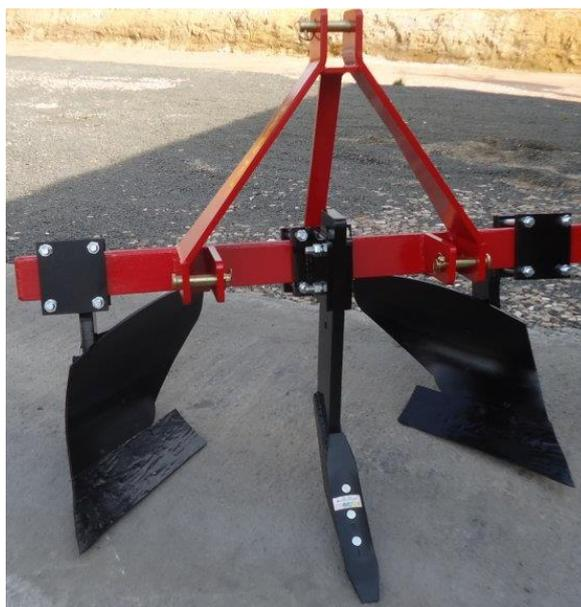
Figura 5 – Aleirador de aiveca para uma linha modelo AAS.
