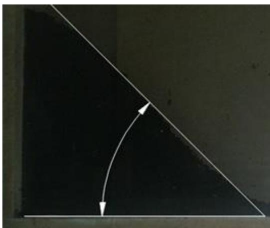
Figura 31 – Método para determinação do ângulo de repouso dos fertilizantes.
