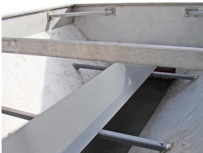
Figura 15 – Sistema de defletor de fertilizantes do modelo Fertiliza 12000.
