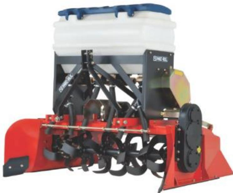
Figura 25 – Enxada rotativa com encanteirador e adubador ERP 115 B.
