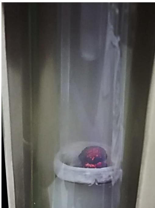
**Figura 6.** Aspecto visual da amostra ainda em processo de combustão após etapa de irradiação.
