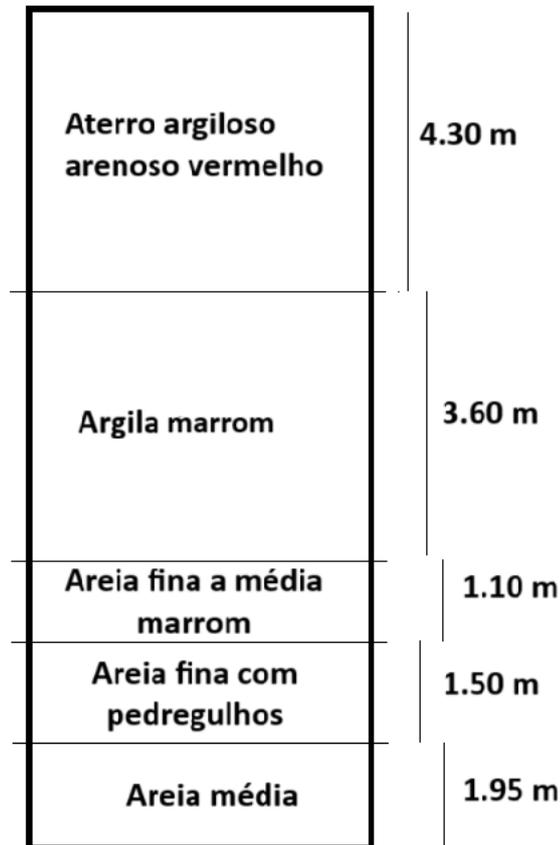
Figura 5.8: Perfil geotécnico do solo de Pelotas/RS.
