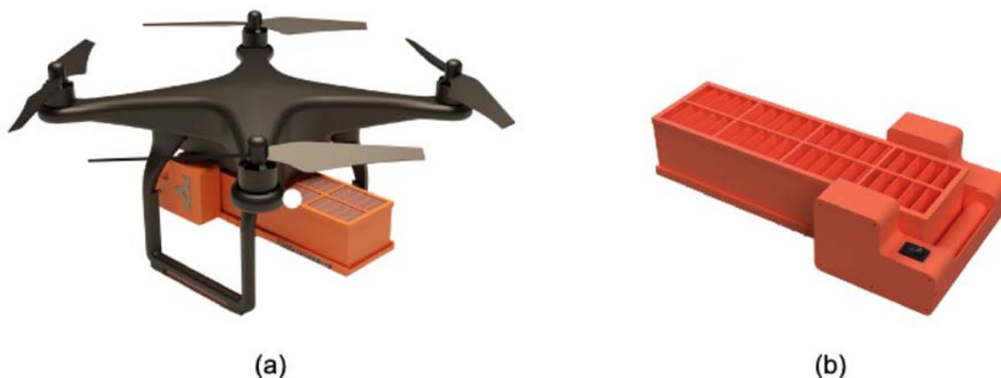
Figura 31 – **Equipamentos utilizados:** (A) DJI Phantom 3 Adv. com dispersador modular acoplado; e (B) Dispersador modular.
