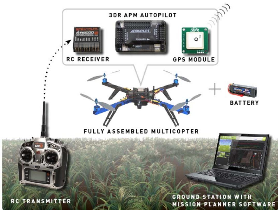
Figura 3 – Multicóptero totalmente montado junto com seus componentes.
