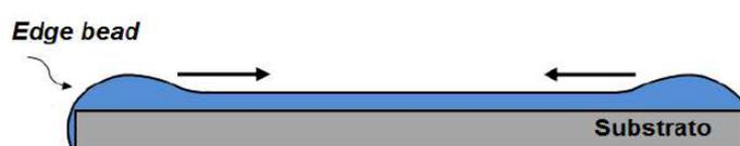
**Figura 9:** Formação de *edge bead* sobre o substrato
