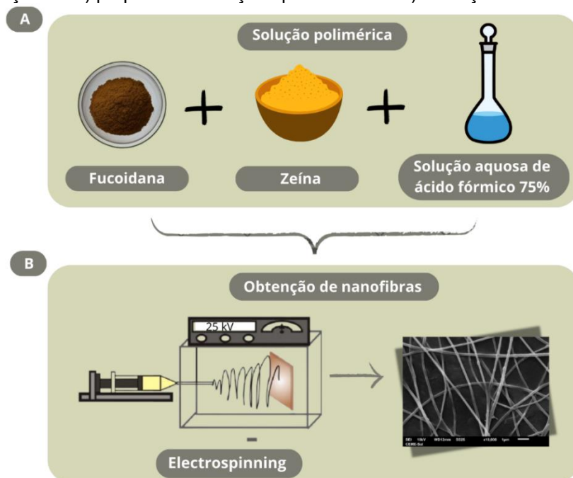
Figura 6 – Ilustração de A) preparo das soluções poliméricas e B) obtenção de nanofibras
