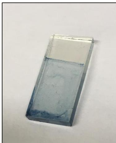
**Figura 11:** Resultado final da fabricação de um filme fino de MoO<sub>3</sub>.
