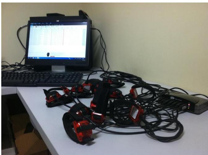
**Figura 3.** Acelerômetros conectados para *download* dos dados.
