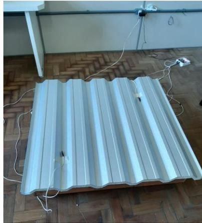
Figura 4 – Ensaio em laboratório e localização dos sensores.
