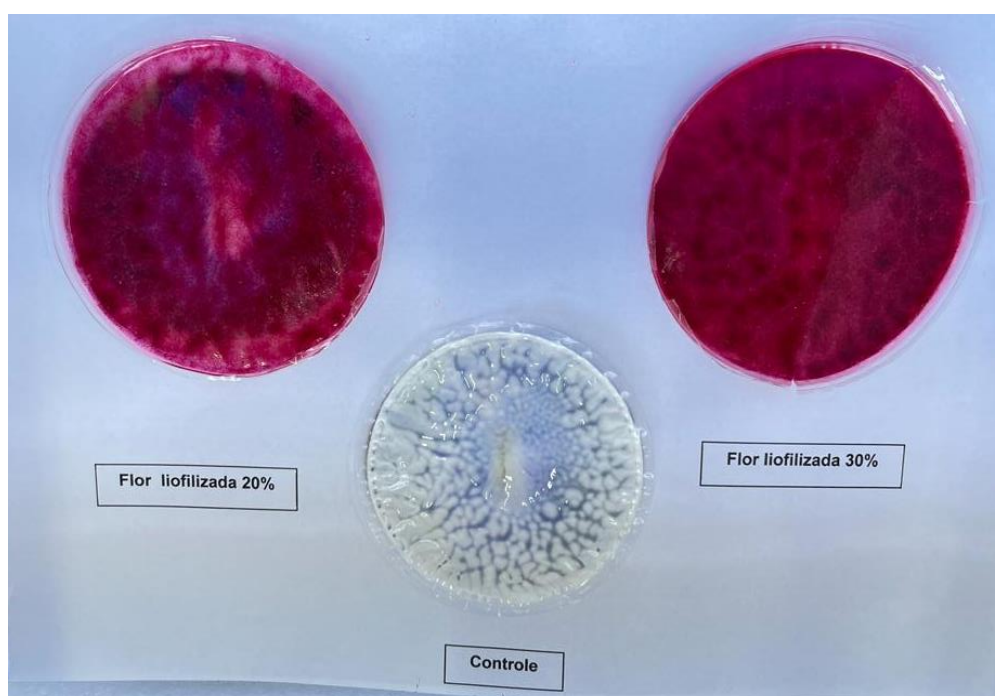
Figura 2. Avaliação macroscópica dos filmes obtidos com 20 e 30% do pó da flor de Clitoria ternatea e filme controle obtido somente com acetato de celulose.
