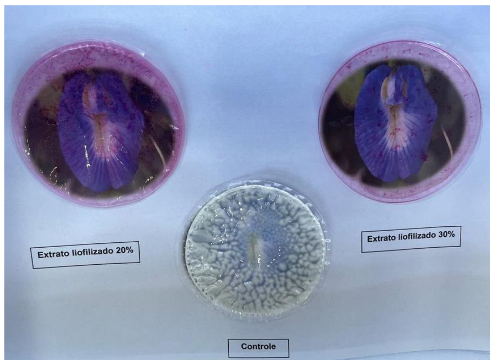
Figura 1. Avaliação macroscópica dos filmes obtidos com 20 e 30 % de extrato liofilizado de Clitoria ternatea e filme controle obtido somente com acetato de celulose.
