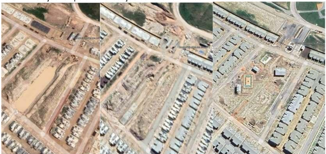
Figura 51-. Evolução temporal da execução do reservatório de Retardo Pluvial
