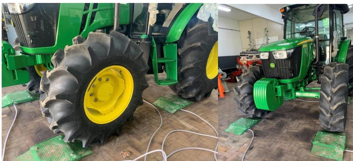
Figura 7 – Posicionamento dos rodados para posterior pesagem
