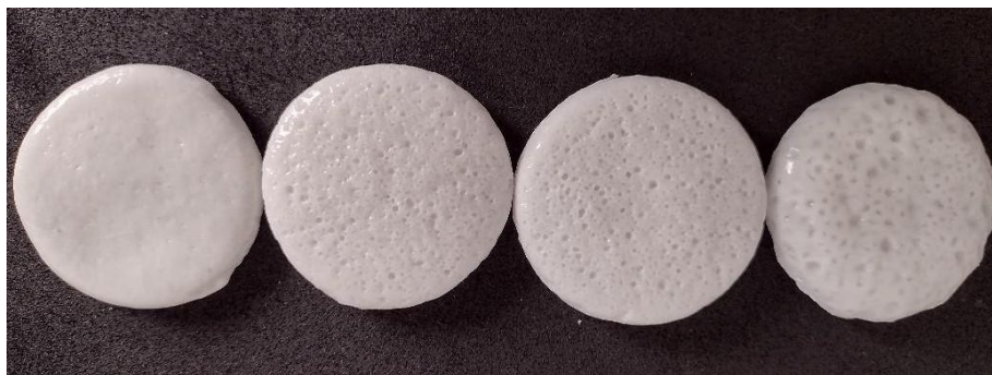
Figura 26 – Imagens espumas vítreas da esquerda para direita com adição de 5%, 6,5%, 8%, 9% de hidróxido de sódio tratados a 850°C
