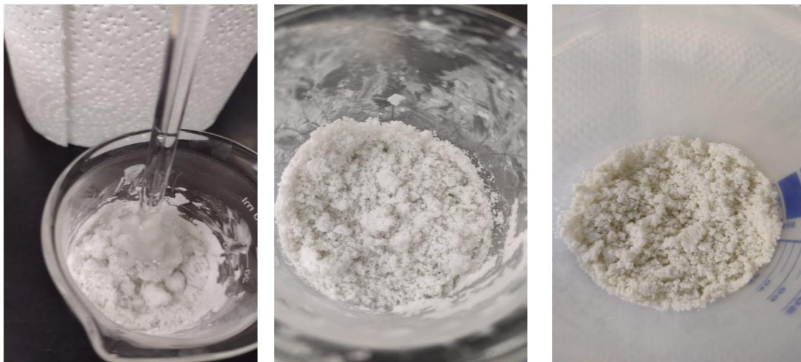
Figura 13 — Imagens do processo de mistura dos componentes, agente espumante e pó de vidro, para a obtenção dos corpos de prova em diferentes formulações.
