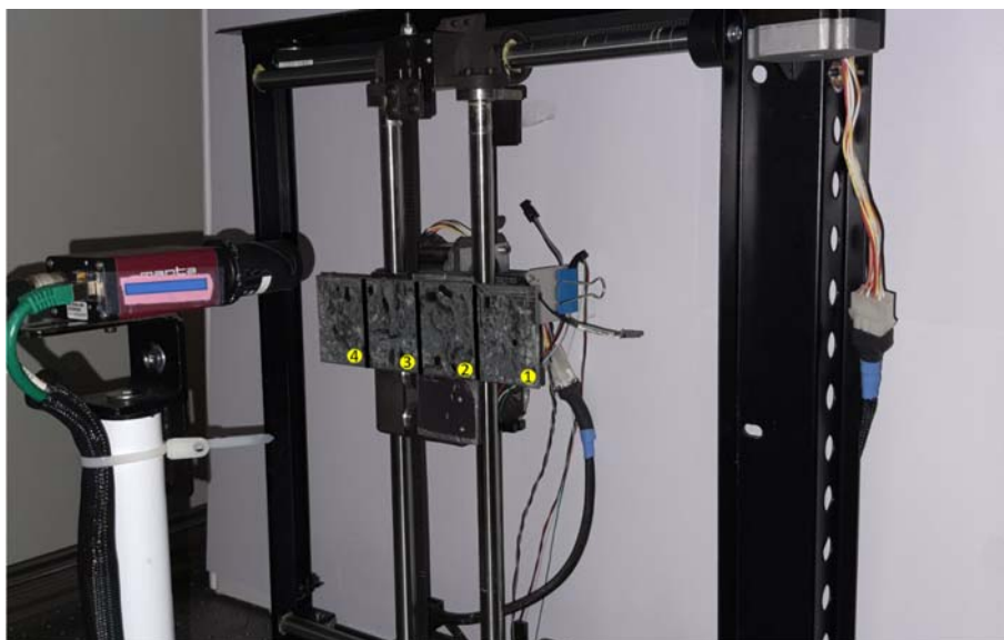
Figura 6 – Sistema de captura de light fields através de um braço mecânico. Fonte: (LUXMAN et al., 2022).
