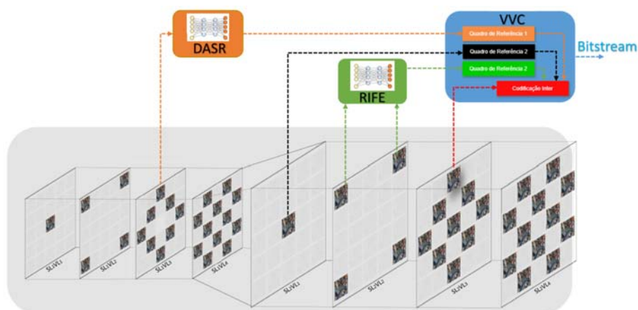
Figura 30 – Estrutura de compressão de light fields proposta por Amirpour et al. (2022) Fonte: Adaptado de Amirpour et al. (2022).
