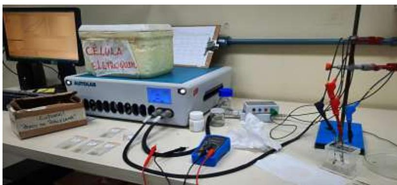
Figura 1: Célula electroquímica e Autolab
