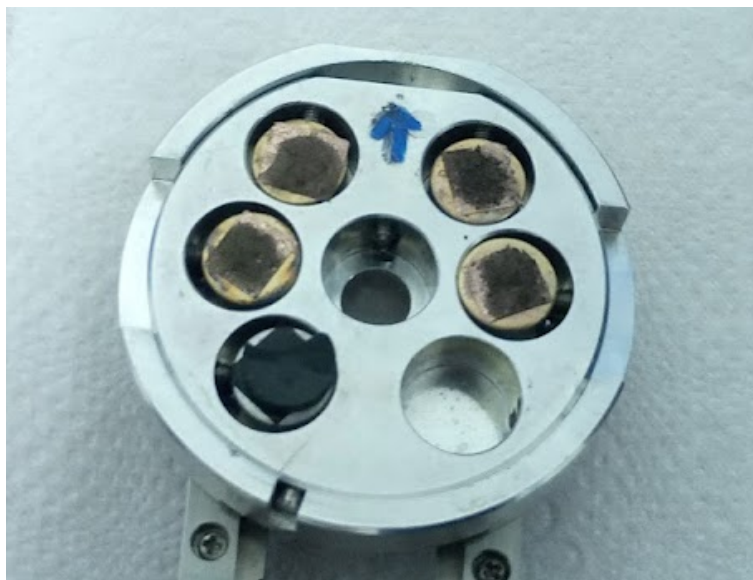
Figura 51 – Porta amostra de alumínio com fragmento da amostra policristalina utilizada neste trabalho
