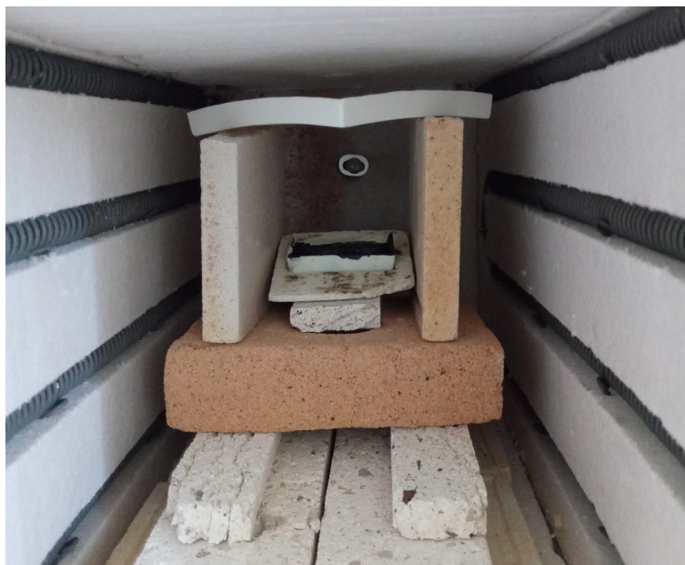
Figura 33 – Disposição do cadinho com inclinação de 20° em relação à horizontal do forno
