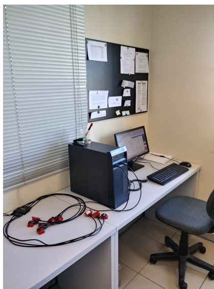
Figura 5 - Acelerômetros conectados no computador destinado ao download dos dados.
