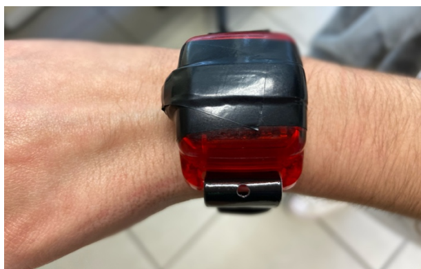
Figura 4 - Posição correta do acelerômetro para fixação ao pulso.
