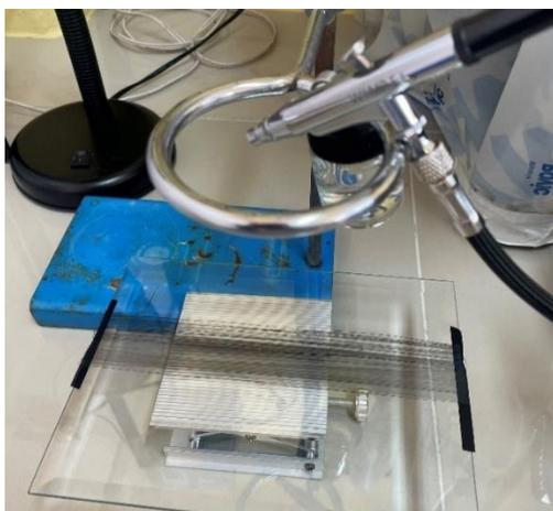
Figura 2: Demonstração de adição de material hospedeiro via spray no filme de nanotubos.
