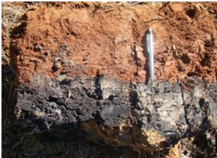
Figura 2 - Camada de Topsoil e de estéril (Overburden) que constituem o solo construído da área experimental.
