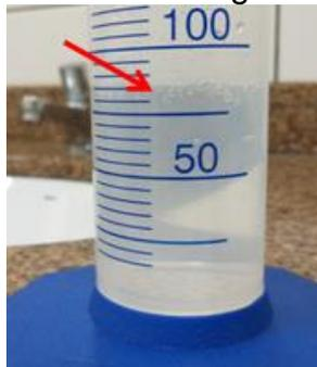
Figura 3: Aferição do vazamento em mictório durante 60 minutos.
