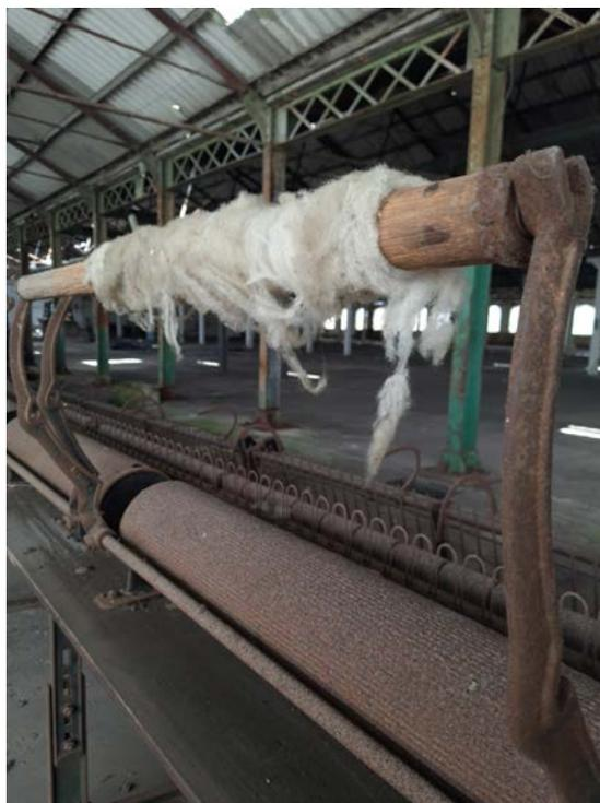
Figura 100: Lã cardada na máquina da fiação. Fonte: Autora, 2023.
