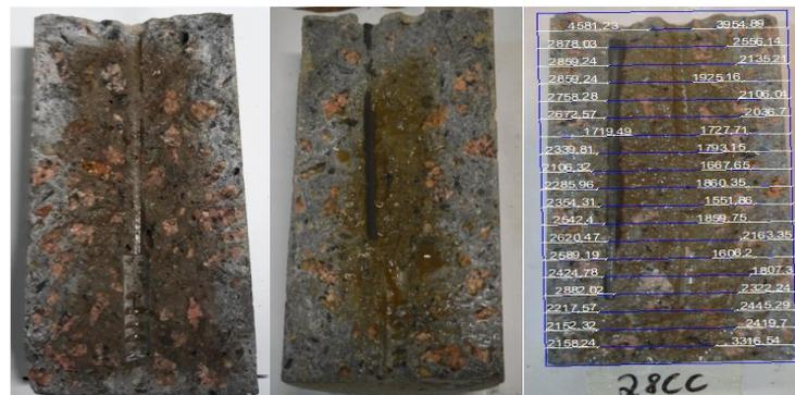
Figura 3: Ensaio Colorimétrico (a, b, c).
