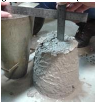
Figura 1 – Teste de Trabalhabilidade (Slump Test)
