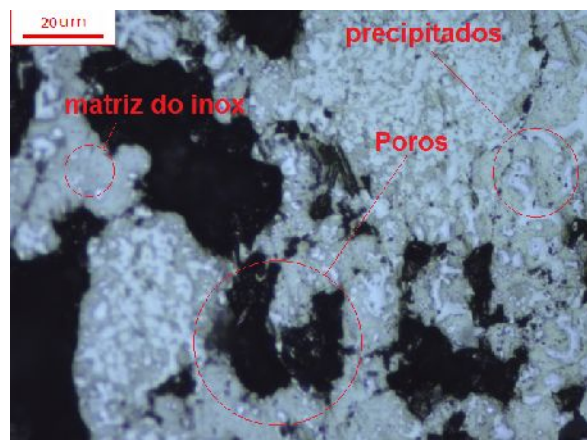
Figura 6: Amostra 316L+B 4 C sinterizada por 60 minutos em micro-ondas
