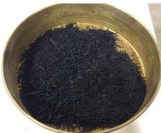
Figura 1 – Resíduo de borracha de pneu.
