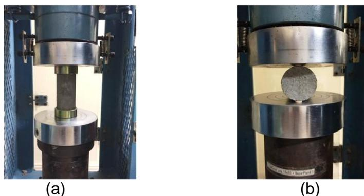
Figura 2 - (a) Ensaio de compressão axial; (b) Ensaio de tração por compressão diametral.
