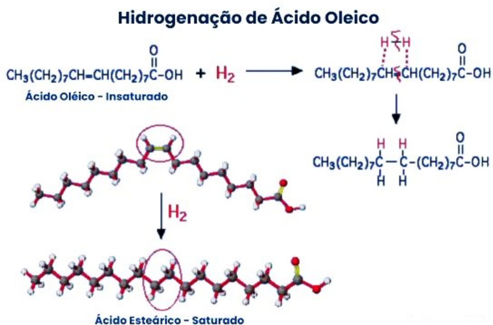
Figura 2 - Hidrogenação de um ácido graxo oleico, adaptada pelo autor
